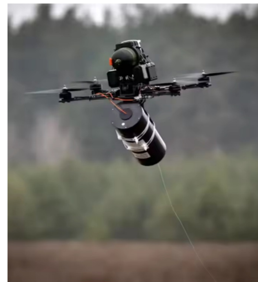
Ukázka typického bojového dronu řízeného po optickém vláknu
