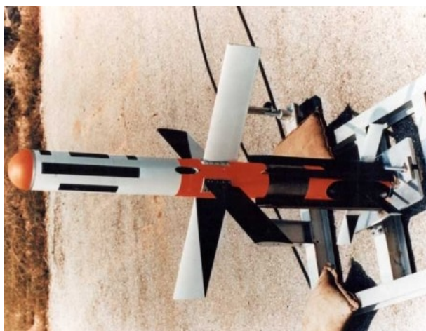
Obrázek 2.6: Střela Y MGM-157B systému EFOGM s cívku optického vlákna v ocasní části. Video z palubní kamery bylo přenášeno po odvíjejícím se vlákně k operátorovi na pozemní stanici. Převzato z [20].
