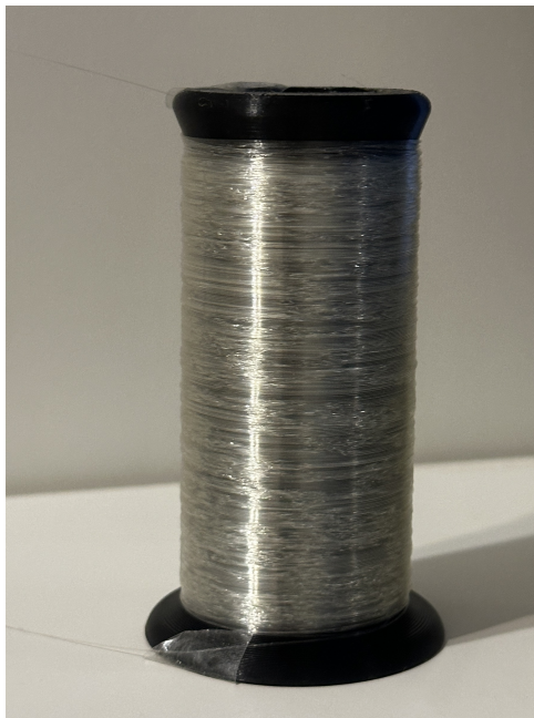
Obrázek 3.12: Výsledný návin optického vlákna na cívce. Rovnoměrně rozložený a napnutý návin zajišťuje plynulé odvíjení během letu.
