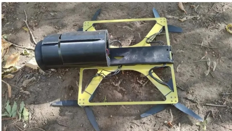
Obrázek 2.7: Ukořistěný ruský FPV dron KVN ( Kníže Vandal Novgorodský ) s viditelnou cívkou optického vlákna připevněnou pod trupem. Dron byl poprvé bojově nasazen v srpnu 2024 v Kurské oblasti. Převzato z [29]
