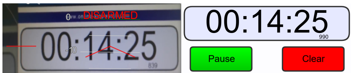
Obrázek 4.1: Měření end-to-end latence videopřenosu. V levé části obrazovky je zobrazen videopřenos z palubní kamery namířené na pravou část obrazovky se spuštěnou online časomírou. Rozdíl mezi zobrazenými hodnotami představuje celkovou latenci řetězce.
