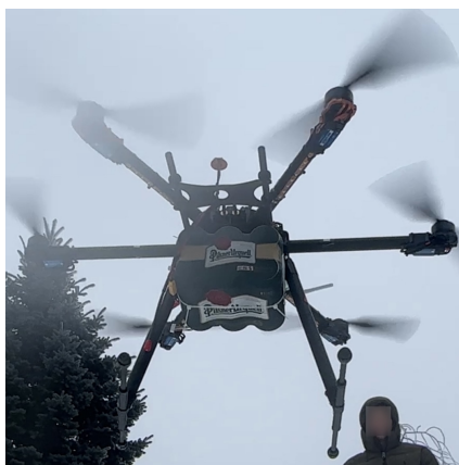
Obrázek 3.2: Zátěžový let testovací platformy v konvenčním provedení s RC přenosem před instalací komunikačního modulu s optickým vláknem. Pod tělem dronu je viditelná zátěž sloužící k ověření nosnosti rámu.
