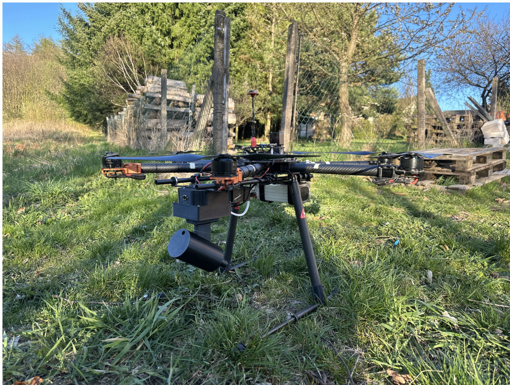
Obrázek 4.2: Testovací platforma připravená ke zkušebnímu letu v kategorii OPEN A3. Pod tělem dronu je viditelný zásobník s návínem optického vlákna a chříč pro plynulé odvíjení během letu.
