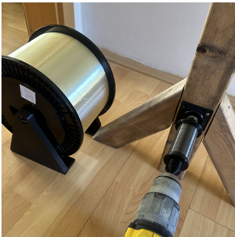
Obrázek 3.11: Navíjecí sestava sestávající z velké dodavatelské cívky (vlevo) osazené v ložiscích, dřevěné konstrukce s ložiskovým domkem a přechodky pro upnutí cílové cívky do aku-vrtačky.
