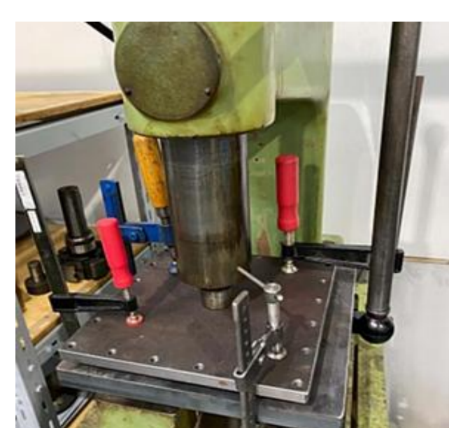
Ruční lis zajistil úplné dovržení formy.
